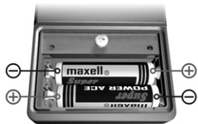
Рис. 3. Схема установки батарей в корпус изделия
