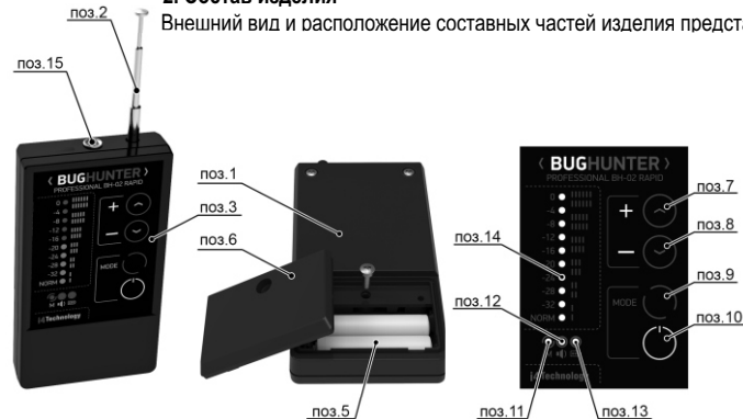
Рис. 2 Расположение составных частей изделия
